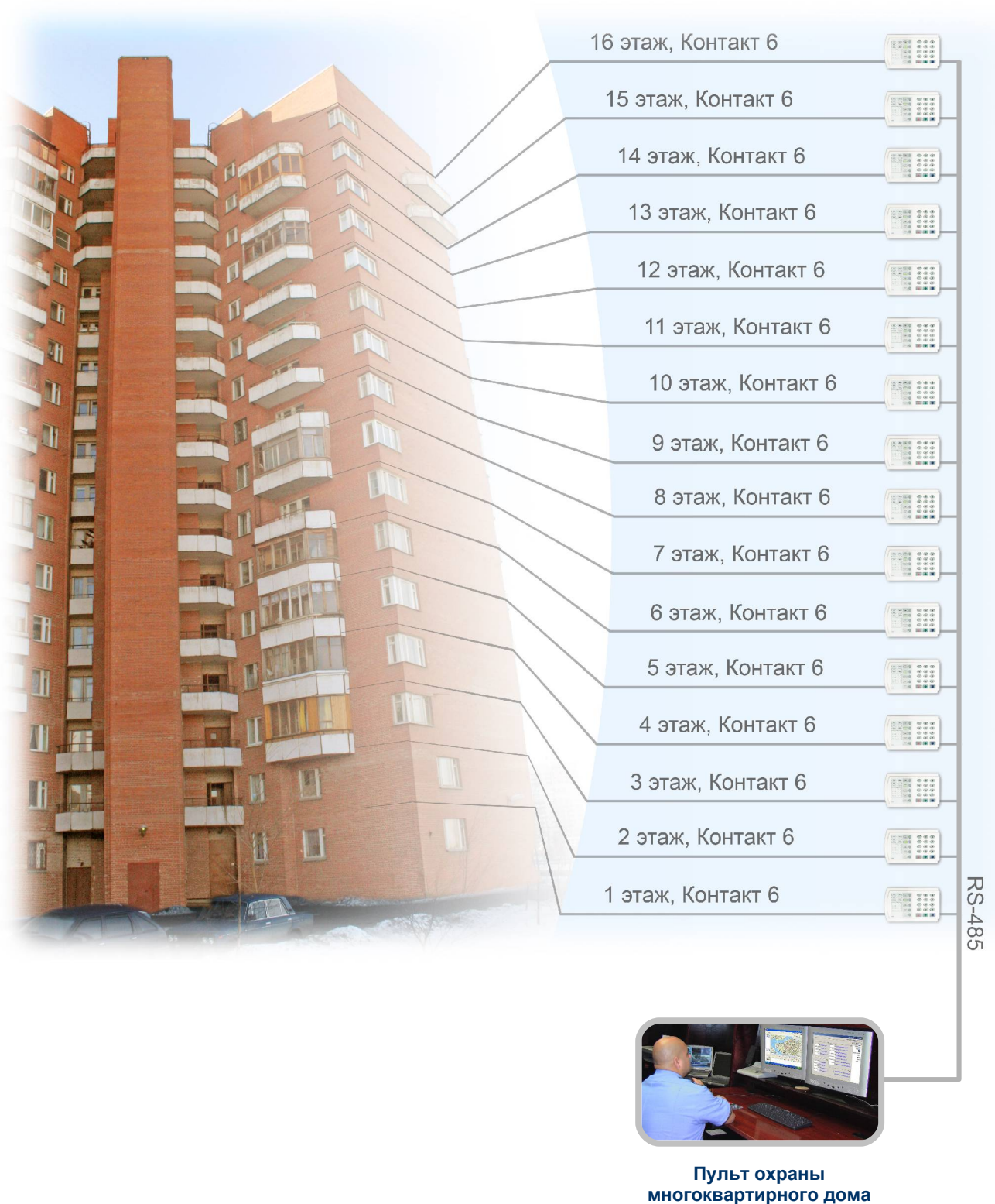
Рис.1.1. Структура системы охраны многоквартирного дома с использованием охранно-пожарных панелей «Контакт 6».
