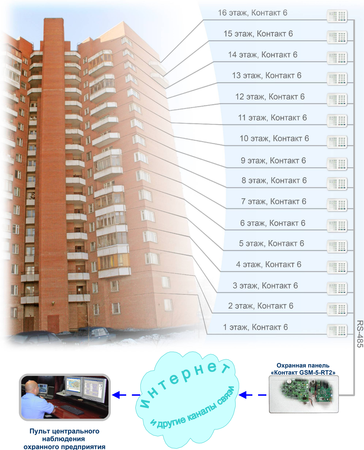
Рис.1.2. Структура системы охраны многоквартирного дома с использованием «Контактов 6» и «Контакта GSM-5-RT2».
